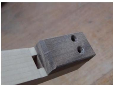
Die Vorschläge fertige so an, dass sie etwa 0.5mm über der Kernkante stehen. Die Pfeife ist jetzt soweit, dass sie probiert werden kann. Die Pfeife wird mit Sicherheit jetzt einen Ton
