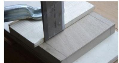
Das Brettchen wird umgedreht und es wird mit einer Feinsäge mit sehr viel Gefühl die Bartseiten geschnitten. Die beiden Schnitte vorsichtig bis knapp vor die Aufschnitthöhe sägen um später noch Korrekturen machen zu können. Diese Arbeit erfordert ein sicheres Führen der Säge und sollte mit einer sog. Japansäge durchgeführt werden.
